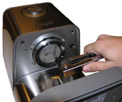
Ta bort och rengör spridarfilterhållaren.
