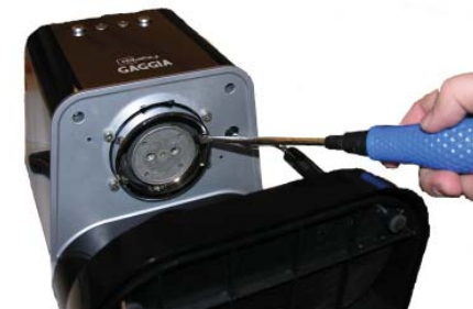
Om spridarfilterhållaren sitter hårt: bänd lätt med en skruvmejsel.
